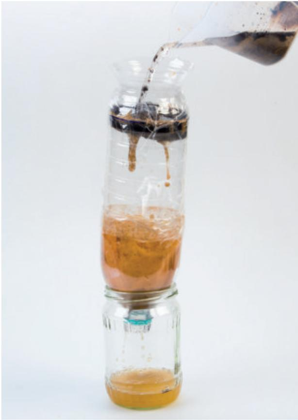
Die selbst gebaute Wasseraufbereitungsanlage.
