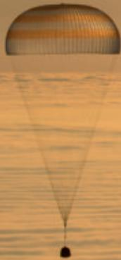
Einige Kilometer über der Erde öffnet sich der Hauptfallschirm, an dem die *Sojus*-Kapsel zu Boden segelt.
