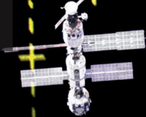
Die Raumstation im Visier des Dockingsystems. Das Bild wurde aus einem amerikanischen *Space Shuttle* aufgenommen. Aber auch die russischen *Sojus*-Raumschiffe verfügen über ein solches System, bei dem die Crew mit einem Periskop den Andockvorgang verfolgen kann. Bild: NASA
