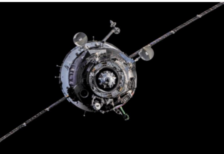
Ein *Sojus*-Raumschiff im Anflug auf die *ISS*. Unten rechts auf der 5-Uhr-Position ragt (gut an der grünen Farbe erkennbar) das Periskop hervor. Das Bild des Periskops wird der Crew auf einen Monitor übertragen. Oben auf 11 und 2 Uhr befinden sich die Antennen des automatischen Dockingsystems. Vorne an der Spitze ist der Andock-Mechanismus zu sehen. Bild: NASA
